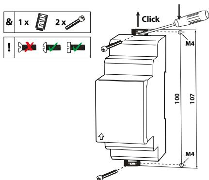
**i** Anwendung in Schienenfahrzeugen nach Norm DIN EN 45545-2:2016! Beträgt der Abstand zu benachbarten Komponenten, die nicht die Anforderung der Norm DIN EN 45545-2 Tabelle 2 erfüllen, horizontal < 20 mm oder vertikal < 200 mm, sind diese als gruppiert zu betrachten.
